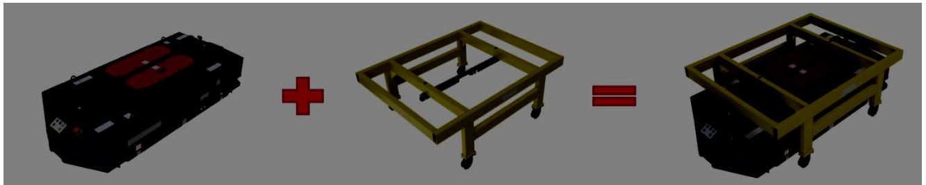
Diagram metody pobierania standardowego wózka przez robota VB500.
