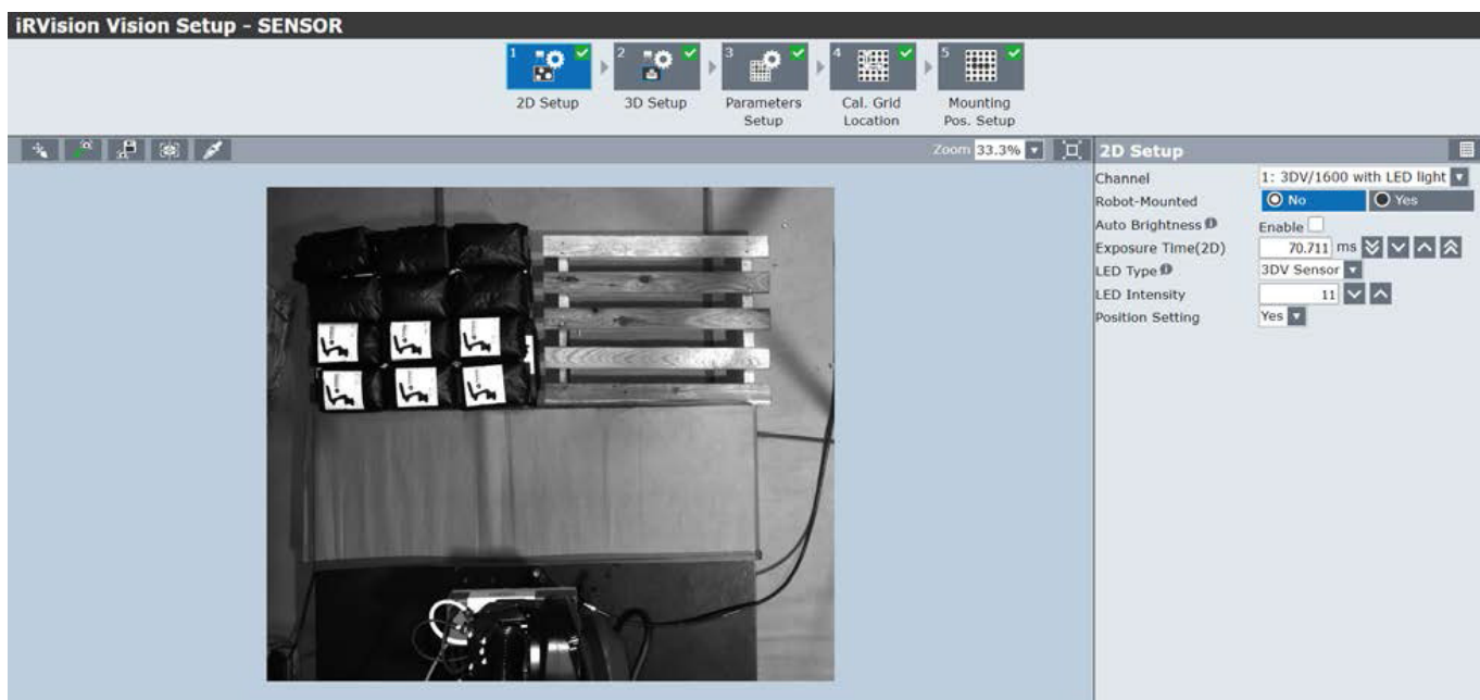
Rysunek 3 Zrzut z ekranu TP przedstawiający okno konfiguracyjne CameraData
